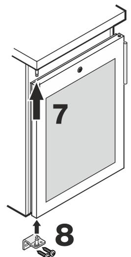
7. Tür wieder in Scharnierbolzen einhängen und schließen.
