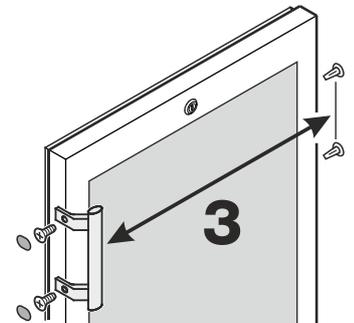
4. Bolzen im Scharnierwinkel umsetzen.
