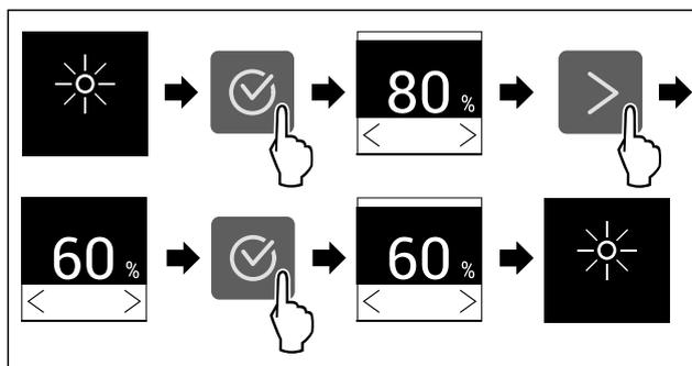
Fig. 44 Beispielhafte Darstellung: Von 80 % zu 60 % wechseln.
