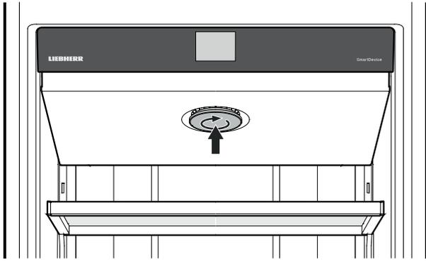
Die Abdeckung einsetzen und im Uhrzeigersinn drehen, bis sie einrastet.
