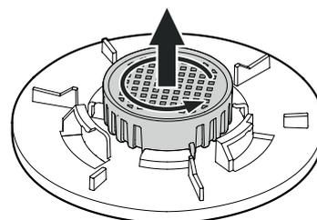
Den neuen Luftfilter einsetzen und im Uhrzeigersinn drehen, bis er einrastet.
