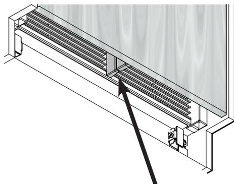
Kontrollieren, dass zwischen Lufttrenner des Gerätes und Lufttrenner der Tür kein Spalt ist.
