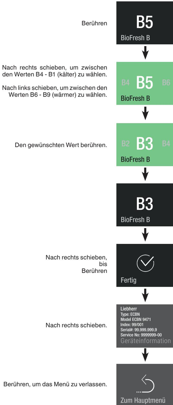
**BioFresh-Plus-Temperaturanpassung (linke Schubfachseite)**
