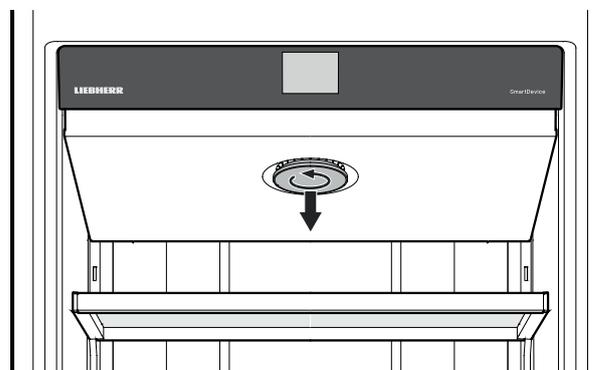
Die Abdeckung gegen den Uhrzeigersinn drehen und entfernen.
