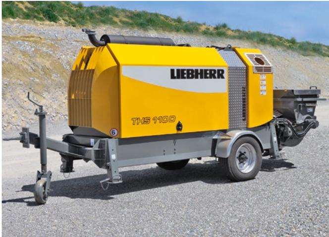
Die Pumpeinheit ist auf einem besonders robusten Stahlrahmen montiert. Das stabile Blechgehäuse sorgt für Wetterchutz und Schallreduzierung. Im Ansaugbereich schützt ein großes Stahlgitter das Kühlsystem und garantiert Reserven bei der Kühlleistung. Alle Komponenten sind kompakt integriert und durch ein modernes Design verkleidet.
