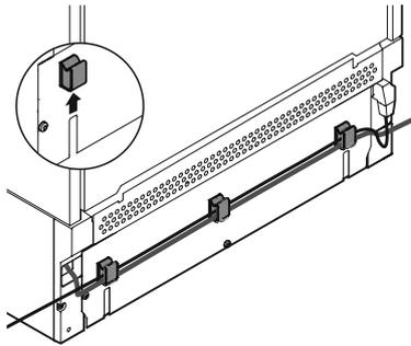
Montar los soportes de cables en la parte posterior del aparato. Colocar la línea de alimentación/tubería de agua en los soportes de cables.
