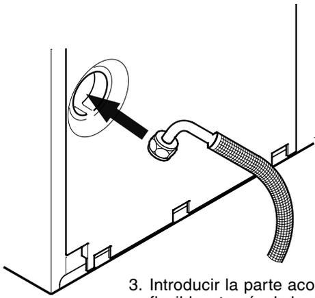
3. Introducir la parte acodada de la tubería flexible a través de la abertura en la parte posterior del aparato.
