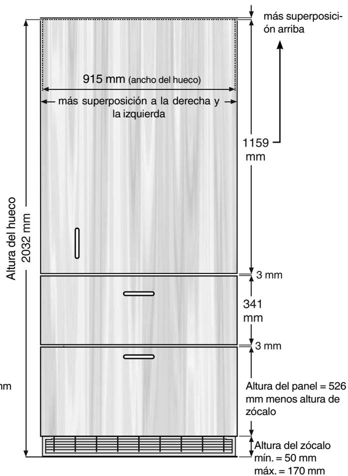
Espesor del panel mínimo = 16 mm
