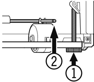
2. La altura puede ajustarse en la parte trasera mediante las barras de ajuste (2).
