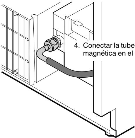
4. Conectar la tubería flexible a la válvula magnética en el frente del aparato.
