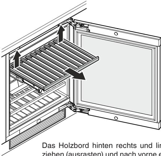
Das Holzbord hinten rechts und links nach oben ziehen (ausrasten) und nach vorne entnehmen.
