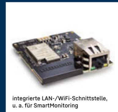
integrierte LAN-/WiFi-Schnittstelle, u. a. für SmartMonitoring
