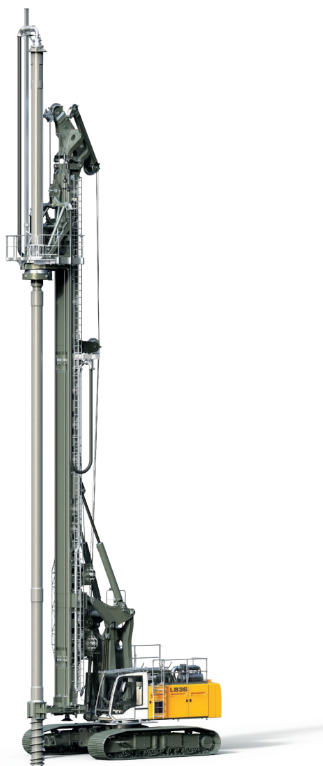
Шнек и направляющая для грунтовытесняющих свай
