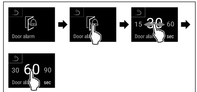
Fig. 77 Représentation à titre d'exemple : modification de l'alarme de porte de 30 secondes à 60 secondes.
