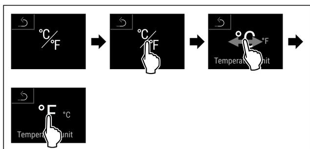
Fig. 46 Représentation à titre d'exemple : Passer du degré Celsius au degré Fahrenheit.
