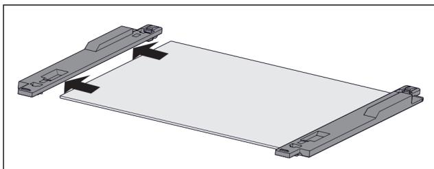
Fig. 35 Glasplatte mit Halteteilen
