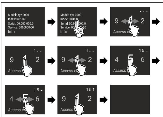
Fig. 4 Beispielhafte Darstellung, Zugang mit Zahlencode **151**
