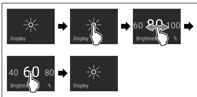
Fig. 44 Représentation à titre d'exemple : Passer de 80 à 60 %.
