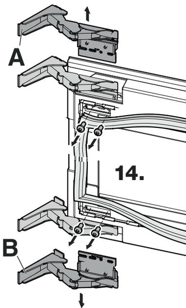
**15.** Desenroscar las placas de fijación de las bisagras y enroscar a la otra bisagra de nuevo (la placa de fijación superior "Top" permanece arriba + la placa de fijación inferior "Bottom" permanece abajo). Volver a atornillar las bisagras en diagonal en las posiciones opuestas de la puerta.
