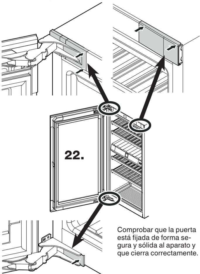
Comprobar que la puerta está fijada de forma segura y sólida al aparato y que cierra correctamente.
