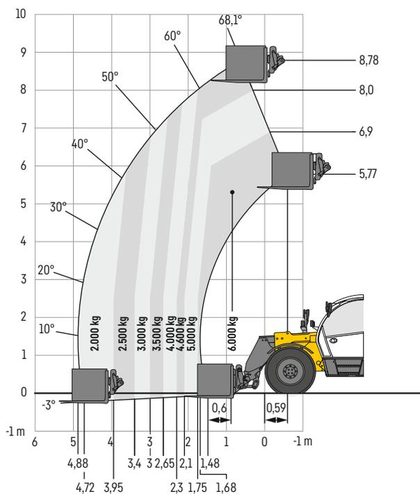
**T 60-9s con bloccaggio dell'asse a pendolo**
