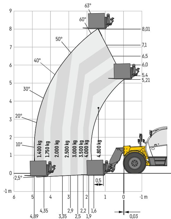
**T 48-8s con bloccaggio dell'asse a pendolo**
