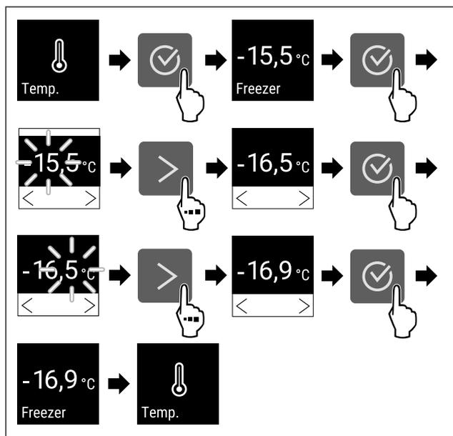
Fig. 69 Changement de température de -15,5 °C à -16,9 °C
