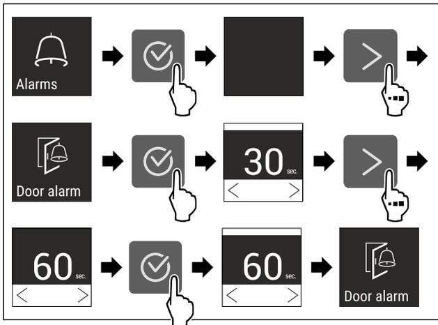
Fig. 135 Représentation à titre d'exemple : modification de l'alarme de porte de 30 secondes à 60 secondes.
