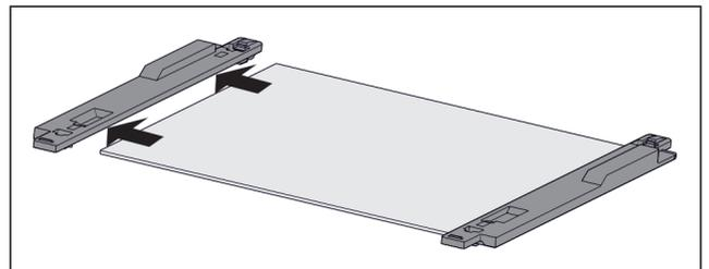
Fig. 111 Glasplatte mit Halteteilen
