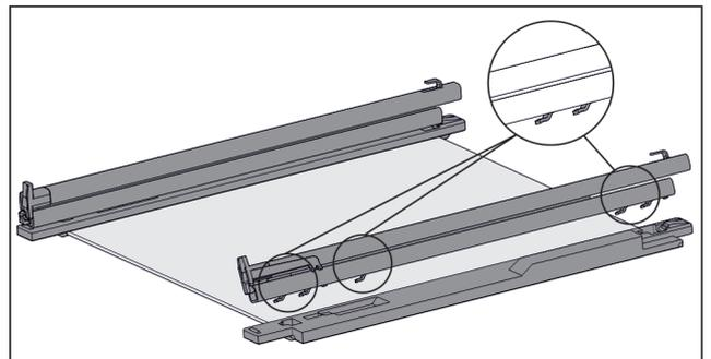
Fig. 110 Glasplatte mit Schienen und Halteteilen
