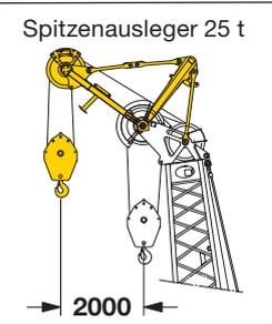
Der Spitzenausleger ist für maximal 25 t Traglast zugelassen. Die dazugehörige Traglasttabelle ist in der LMB programmiert.
