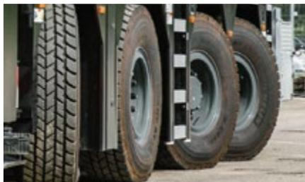
Speziell entwickelte Mobilkranreifen
