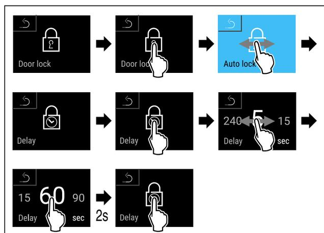
Fig. 84 Folgende Werte sind einstellbar: 5, 15, 60, 90, 120, 180 und 240 Sekunden
