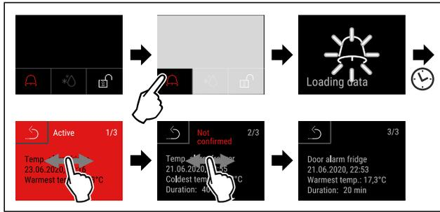
Fig. 231 Beispiel zeigt einen aktiven Alarm, einen nicht bestätigten Alarm und einen bestätigten Alarm.
