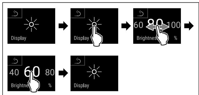
Fig. 125 Beispielhafte Darstellung: Von 80 % zu 60 % wechseln.
