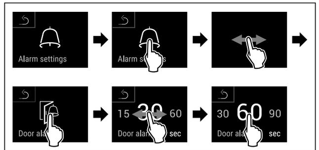
Fig. 183 Beispielhafte Darstellung: Türalarm von 30 Sekunden zu 60 Sekunden wechseln.
