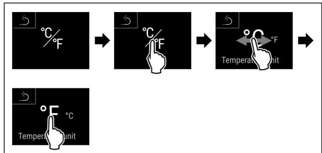
Fig. 123 Beispielhafte Darstellung: Von Grad Celsius zu Grad Fahrenheit wechseln.
