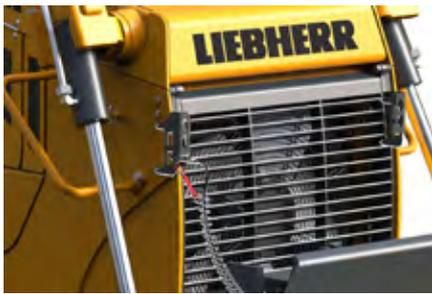
Câblage complet à l'intérieur des consoles pour le montage des mâts et module pour la télétransmission de données.
