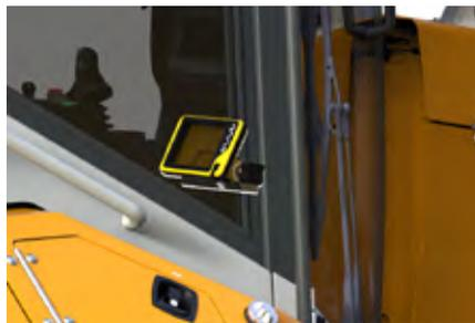
Embase de montage et connexions pour l'unité de commande (moniteur) dans la cabine. Pour une maniabilité ergonomique, l'interrupteur automatique est habituellement intégré dans le joystick.
