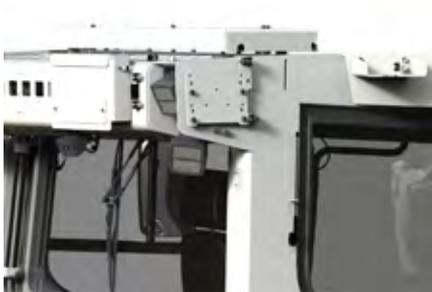
Câble de raccordement et possibilité de montage sur la cabine pour le radio-transmetteur de données pour l'exploitation du GPS/GNSS ou du tachéomètre.
