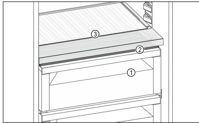
Fig. 106 Rappresentazione a titolo di esempio del coperchio dello scomparto del vano di sicurezza Fruit & Vegetable
