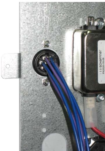
Fertig verdrahtete Einbaudose (-X101).
