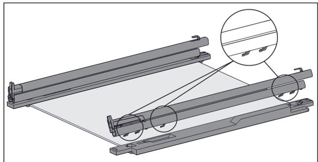
Fig. 49 Glasplatte mit Schienen und Halteteilen
