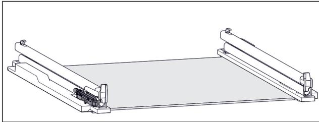
Fig. 52 Dämpfungseinheit
