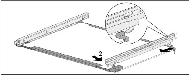
Fig. 45 Glasplatte mit Schienen
