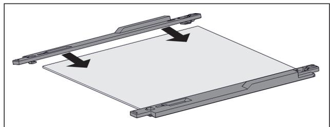
Fig. 51 Glasplatte mit Halteteilen
