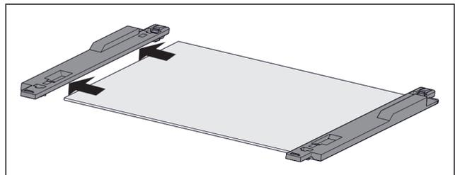
Fig. 50 Glasplatte mit Halteteilen
