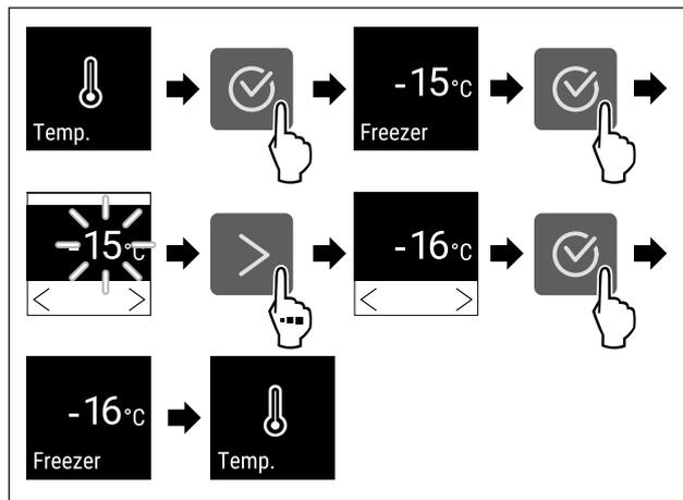
Fig. 59 Variazione di temperatura da -15 °C a -16 °C
