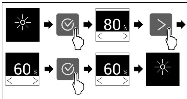
Fig. 58 Representación a modo de ejemplo: Cambiar de 80 % a 60 %.
