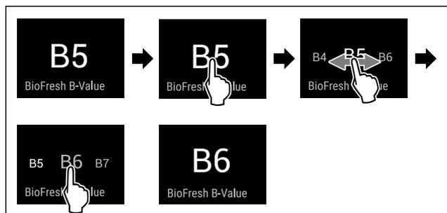
Fig. 25 Beispielhafte Darstellung: Von B5 zu B6 wechseln.
