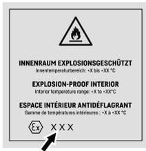
Fig. 3 Classe de protection : **II 3/-G Ex ec IIC T6 Gc/-**
