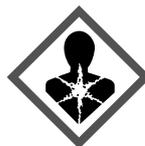
Le symbole peut se trouver sur le compresseur. Il se réfère à l'huile dans le compresseur et signale le danger suivant : **Peut être mortel en cas d'ingestion ou de pénétration dans les voies respiratoires.** Cet avertissement ne concerne que le recyclage. Il n'y a aucun danger pendant le fonctionnement normal.
