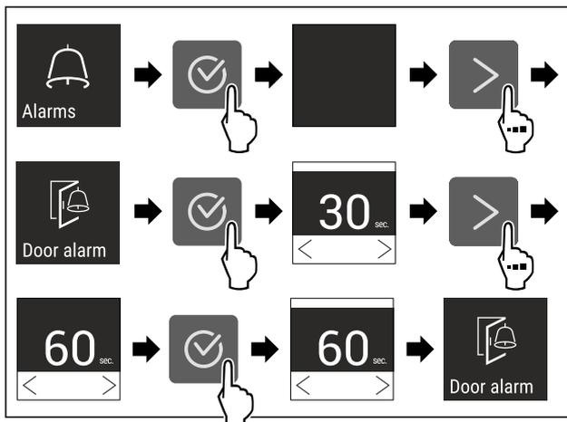
Fig. 181 Représentation à titre d'exemple : modification de l'alarme de porte de 30 secondes à 60 secondes.
