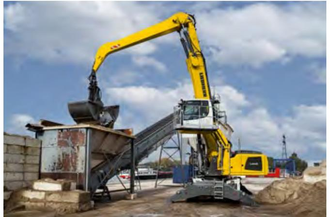
Alimentación de una planta de hormigón con la LH 40 M Industry Litronic
