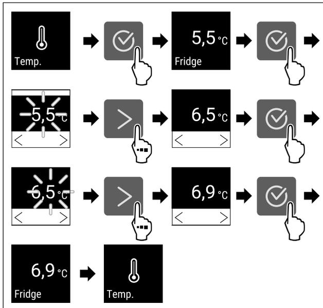
Fig. 75 Temperaturwechsel von 5,5 °C auf 6,9 °C
