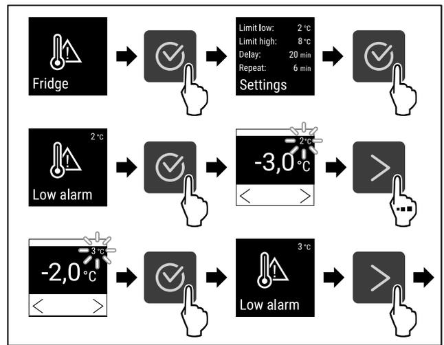
Fig. 137 Beispiel für die Einstellung der Temperaturuntergrenze, basierend auf einer eingestellten Gerätetemperatur von 5 °C.
