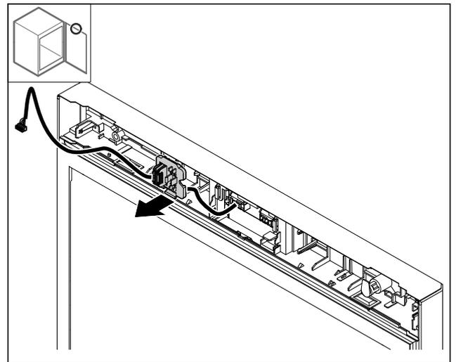
Fig. 30 Die Einbauposition der Steckerhalterung kann um 180° gedreht sein.
