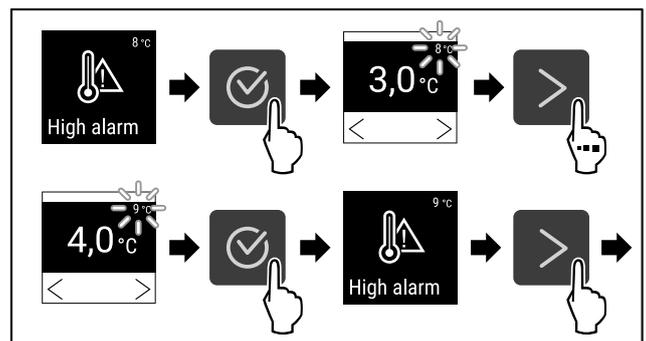
Fig. 138 Beispiel für die Einstellung der Temperaturuntergrenze, basierend auf einer eingestellten Gerätetemperatur von 5 °C.
