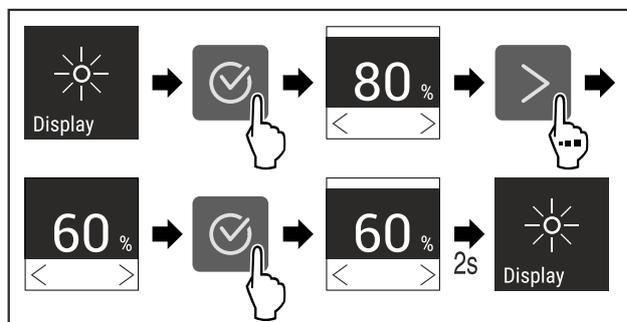
Fig. 96 Beispielhafte Darstellung: Von 80 % zu 60 % wechseln.
