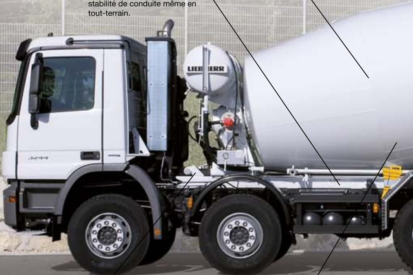
Système d'entraînement de la cuve généreusement dimensionné pour un fonctionnement fiable et durable.
