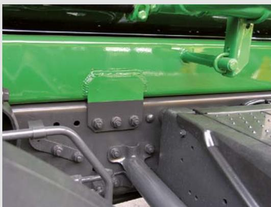
Le faux-châssis du malaxeur est exécuté à partir du même type d'acier que le châssis. Les deux cadres sont ainsi dotés des mêmes propriétés. La structure du malaxeur et le châssis sont définis de façon optimale l'un par rapport à l'autre, en particulier pour les travaux sur chantier.
