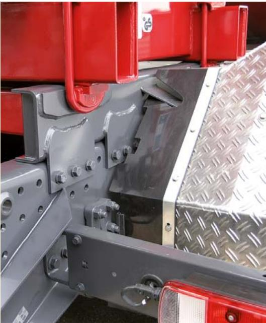
**Protection entre ailes et faux-châssis**
