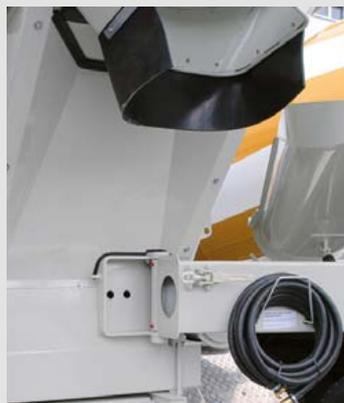
Goulotte pivotante avec support monobloc, facile à manier, pouvant être pivotée sur le côté pour le nettoyage avec le bras de support.
