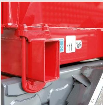
La fixation par brides assure une transmission de la force dynamique dans le cadre du malaxeur. Les brides sont étroitement positionnées dans le cadre.
