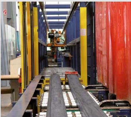
Les faux-châssis du malaxeur dont les tôles sont découpées au laser sont mis à la forme adaptée au châssis correspondant à l'aide d'une plieuse à commande numérique.
