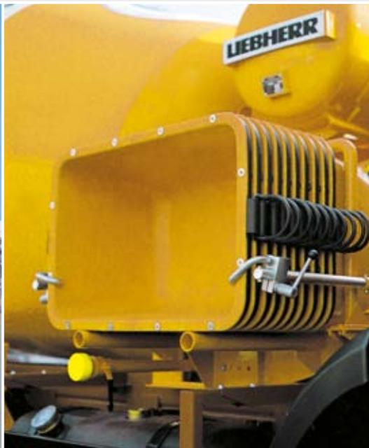
**Support de benne à mortier**
