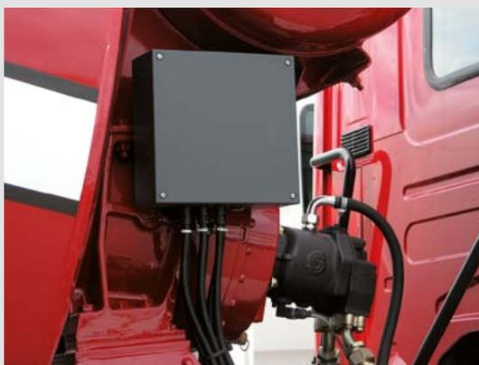
Le système électronique de la commande de la bétonnière portée est disposé à un endroit protégé, seul l'élément de commande se trouve à l'arrière.
