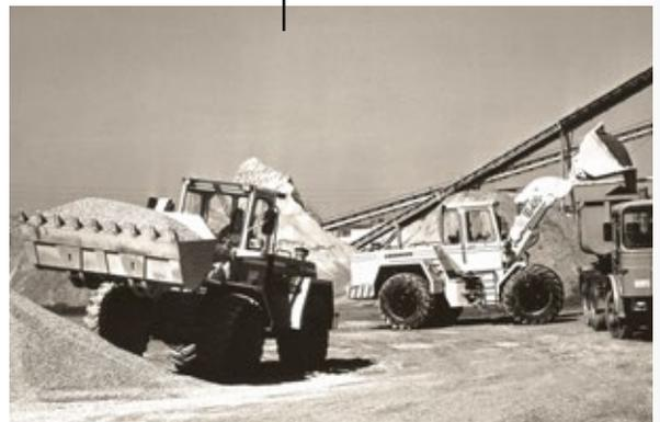
Die Radlader L 531 und L 541 feiern Premiere. Ihr hydrostatischer Fahrantrieb verringert den Kraftstoffverbrauch. Die stufenlose Übersetzung ist für Nutzfahrzeuge ideal und die Bremsen sind nahezu verschleißfrei.
