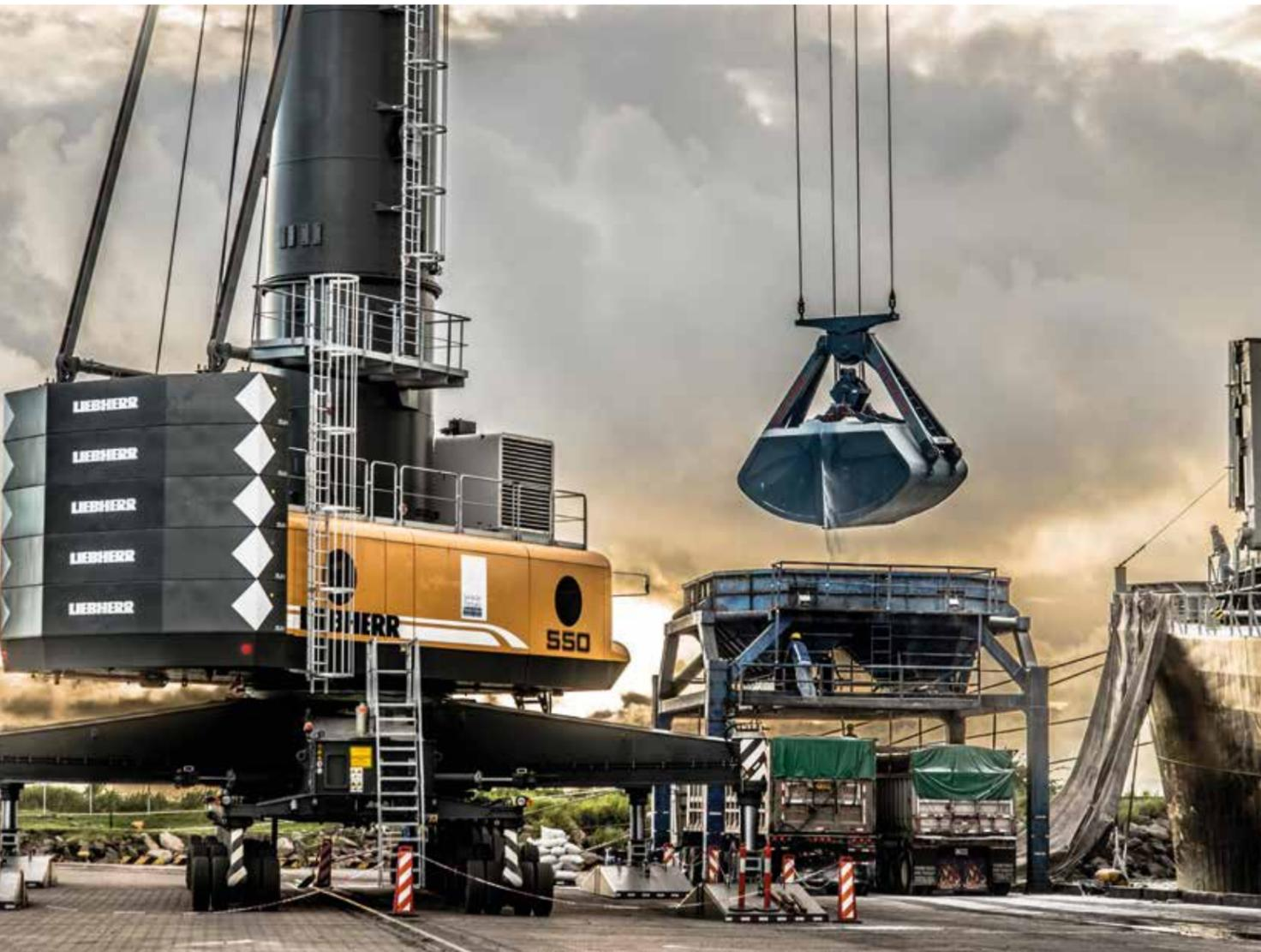
В конструкции мобильного портового крана Liebherr используется исключительно модульный принцип, который призван обеспечить соответствие требованиям любого порта. Верхняя часть кранов (поворотная платформа, башня и стрела) остается по сути одинаковой. Однако в зависимости от условий и требований в порту доступны несколько вариантов основания, т.е. имеется пять различных решений в сфере подъемных кранов.
