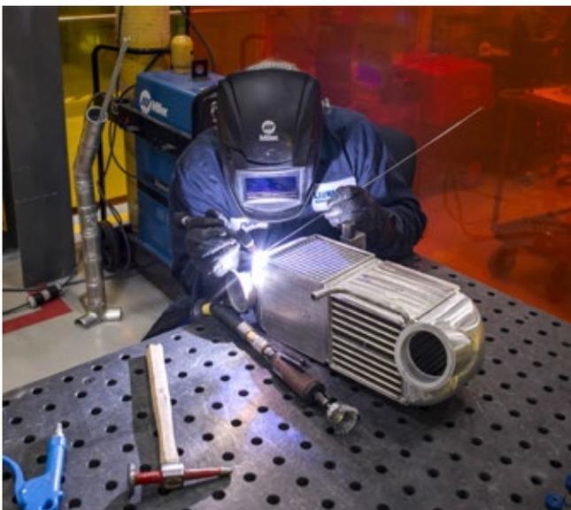
Ein Schmelzschweißer in Saline (MI/USA), erzeugt eine Schweißnaht auf einem Wärmetauscher
