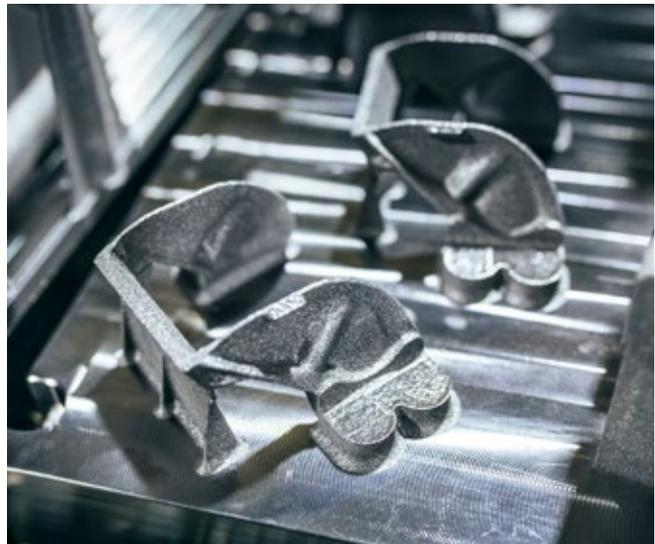
Zwei im 3D Drucker hergestellte Sensorhalter für das Bugfahrwerk des Airbus A350
