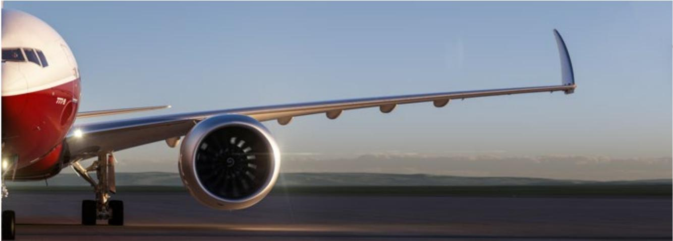
Die Boeing 777X wird mit der Liebherr-Technologie für das Flügelenden-Klappantriebssystem ausgestattet. Damit ist es das erste Verkehrsflugzeug in der Geschichte mit Klappmöglichkeit.
