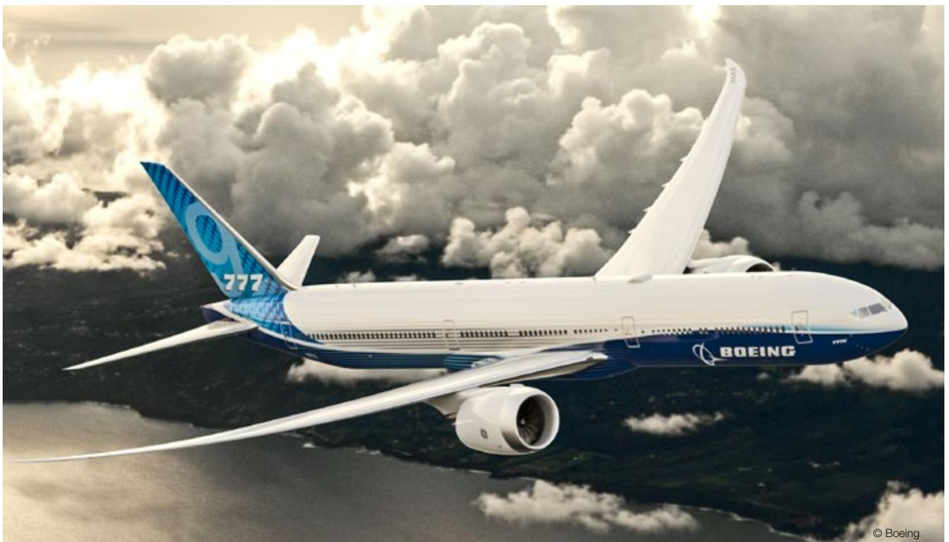
Mit der 777X halten neueste Technologien Einzug, einschließlich des fortschrittlichsten kommerziellen Triebwerks aller Zeiten und eines neuen hocheffizienten Verbundflügels, der eine längere Spannweite aufweist als der der 777
