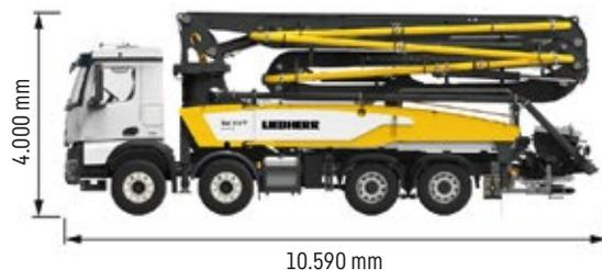
Modelo estándar. Las dimensiones y el peso total pueden variar según el tipo de bomba y el chasis.
