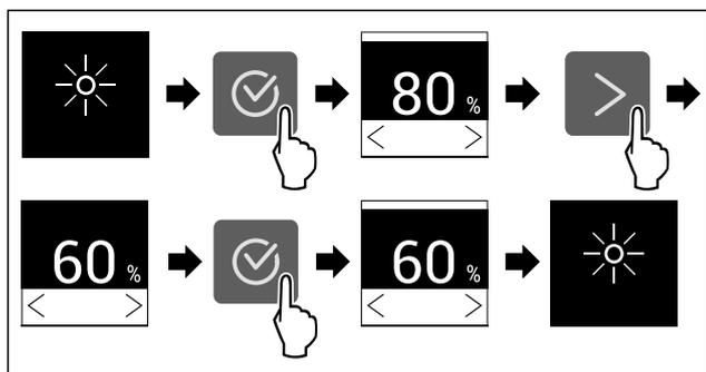
Fig. 60 Beispielhafte Darstellung: Von 80 % zu 60 % wechseln.
