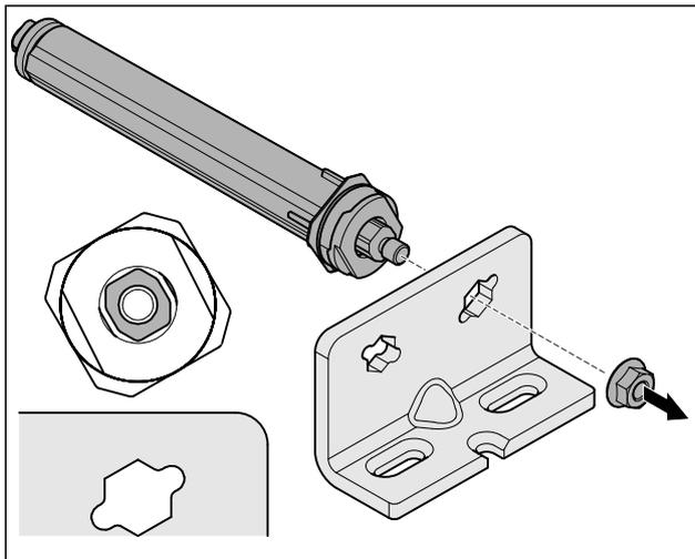
Fig. 29 Montaje de las bisagras a la derecha
