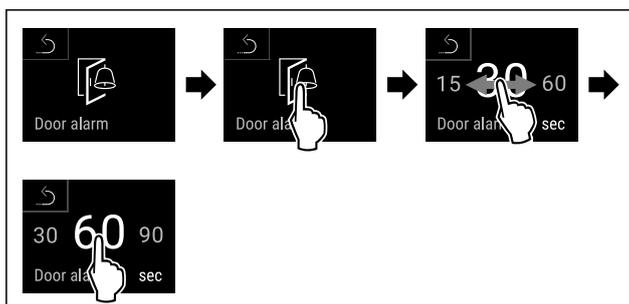
Fig. 157 Representación a modo de ejemplo: Cambiar alarma de puerta de 30 segundos a 60 segundos.
