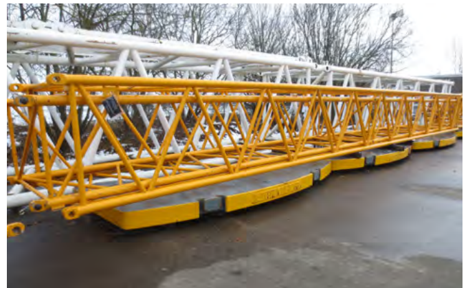
Ausrüstungsteile wie Gittersektionen, Hilfsausleger und Klappspitzen
