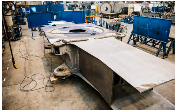
Vorbereitung eines Rahmenteiles für die Unfallinstandsetzung
