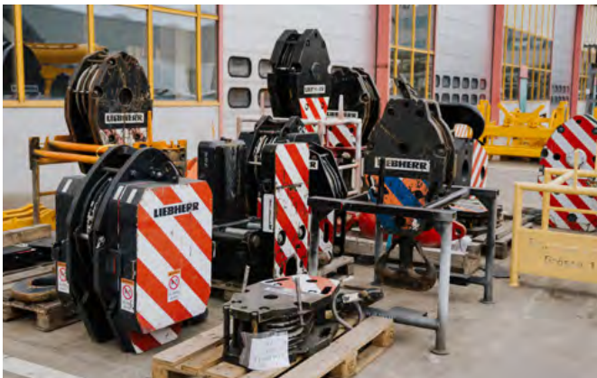
Lasthaken und Hakenflaschen in verschiedenen Varianten
