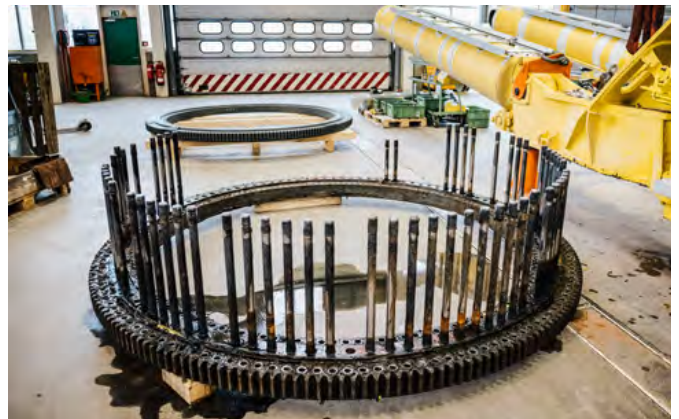
Drehkranzüberprüfung mit anschließender Erneuerung
