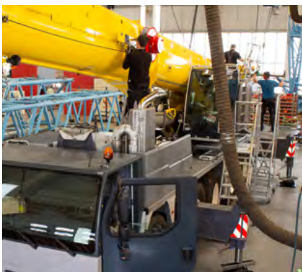
Zusammenbau nach Wiederaufbereitung der Komponenten
