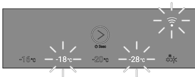
Fig. 46 Écran en cas d'erreur WLAN
