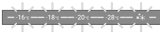
Fig. 44 Écran en cas d'alarme de température
