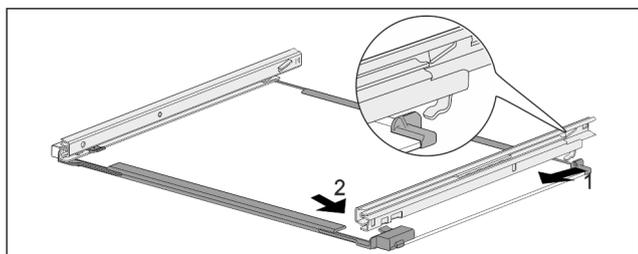
Fig. 92 Placa de vidrio con guías
