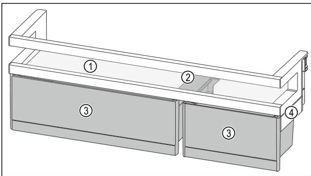
Fig. 106 Représentation à titre d'exemple d'un balconnet de contre-porte avec VarioBoxes
