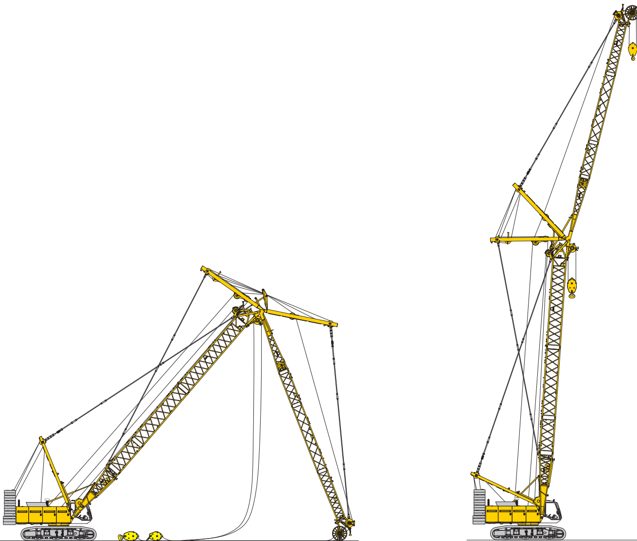
Подъем основной стрелы и управляемого удлинителя стрелы
