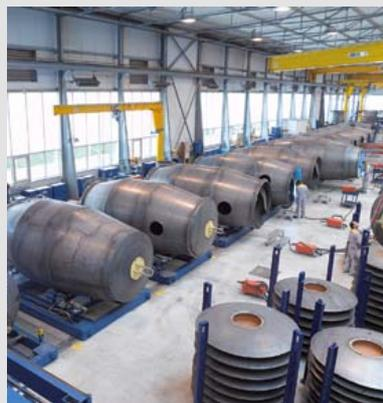
Bei Liebherr werden alle Schlüsselkomponenten, wie zum Beispiel die Mischertrommeln im eigenen Haus produziert.
