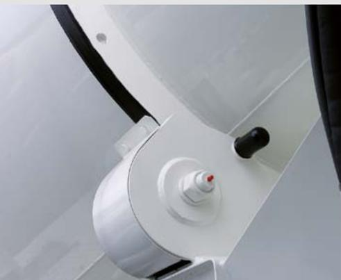
Die breit positionierten Laufrollen sorgen für eine gute Trommelaufgabe. Bei Revisionsarbeiten an der Trommel kann diese über eine formschlüssige Trommelsicherung zuverlässig fixiert werden.
