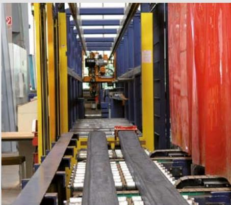
CNC-gesteuert werden die Mischerhilfsrahmen lasergenau in die für das jeweilige Chassis passende Form gepresst.
