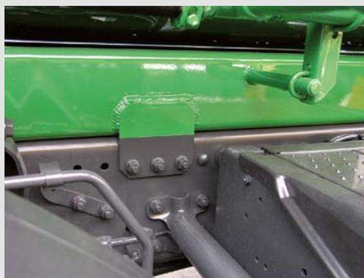
Der Mischerhilfsrahmen ist aus der gleichen Stahlsorte wie der des Chassis, daher haben beide Rahmen die gleichen Eigenschaften. Mischeraufbau und Chassis sind optimal aufeinander abgestimmt, insbesondere beim Baustelleneinsatz.
