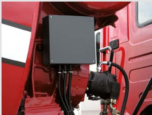
Die Elektronik der Fahrmischersteuerung ist an geschützter Stelle untergebracht, am Heck befindet sich lediglich das Bedienteil.
