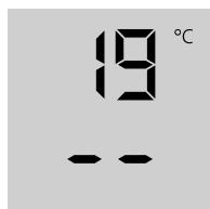
При запуску в експлуатацію і поки прилад теплий, на індикаторі відображаються штрихи до тих пір, поки температура не досягне діапазону індикації (нижче 0 °C у морозильній камері).
