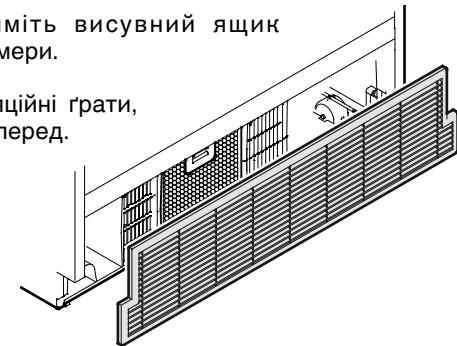
4. Натисніть кнопку на фільтрі, нахиліть фільтр вперед і вийміть його.
