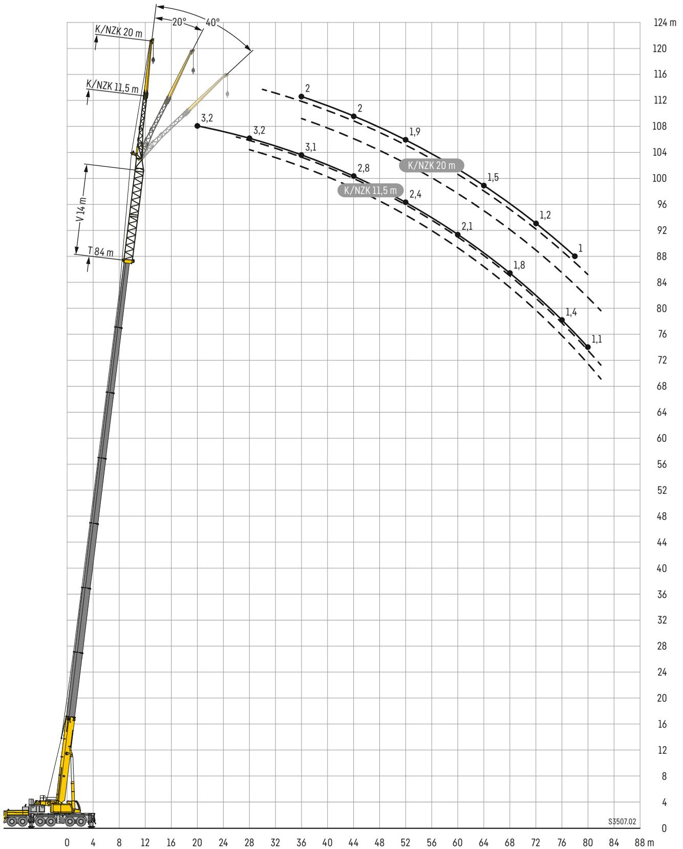
Lifting capacities • Forces de levage • Portate • Tablas de carga • Грузоподъемность
