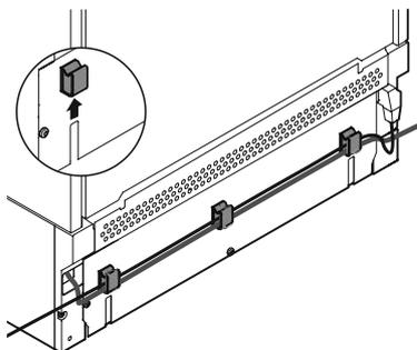
Monter les supports de câble à l'arrière de l'appareil. Placer le câble d'alimentation/la conduite d'eau dans les supports de câble. Introduire l'appareil dans la niche.
