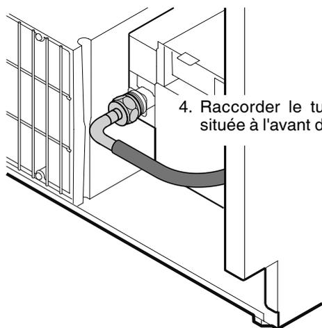
4. Raccorder le tuyau à l'électrovanne située à l'avant de l'appareil.
