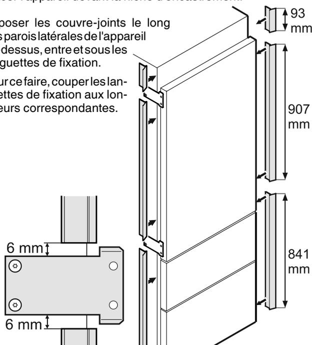
Apposer les couvre-joints en respectant un espace de 6 mm de part et d'autre de chaque languette de fixation.
