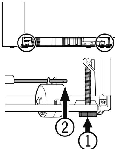
2. Ajuster la hauteur à l'arrière de l'appareil à l'aide des barres d'ajustage (2).
