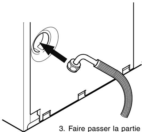
3. Faire passer la partie coudée du tuyau par l'ouverture située à l'arrière de l'appareil.
