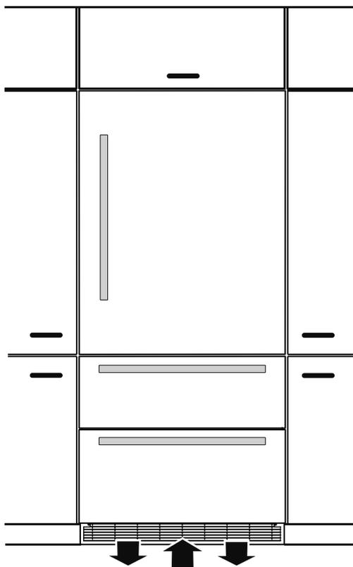
Le débit d'air nécessaire s'effectue dans le socle.
