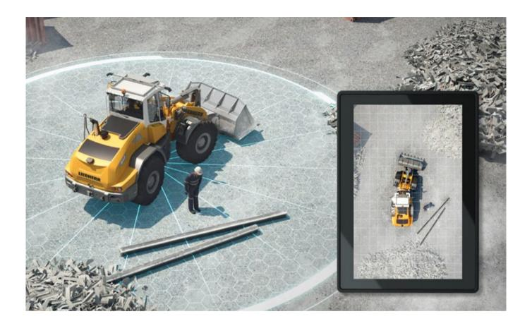
Tout sous les yeux : le système d'assistance « Skyview 360° » a été fondamentalement remanié et séduit par sa qualité d'image haute résolution Le système offre une vue d'ensemble complète de toute la zone environnante de la machine, ce qui permet de détecter à temps les sources de danger et d'éviter les accidents. Les cycles de travail peuvent être exécutés plus rapidement, plus efficacement et plus sûrement, ce qui permet de gagner du temps et de réduire les coûts.
