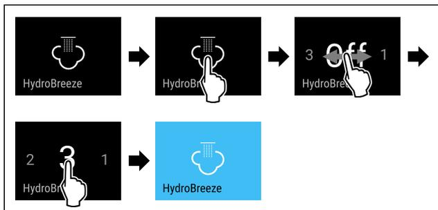
Fig. 55 Representación a modo de ejemplo: Activar el HydroBreeze al valor 3.
