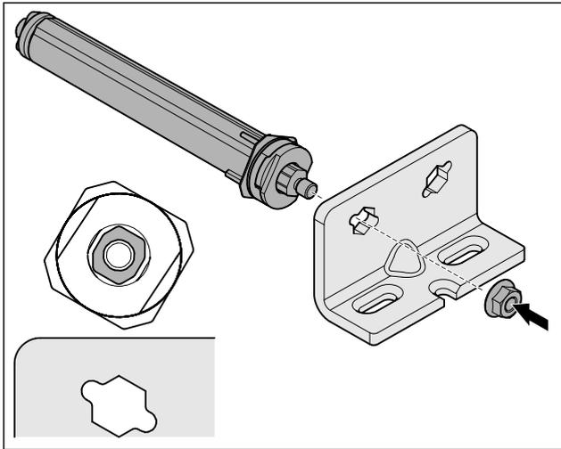
Fig. 32 Montaje de las bisagras a la izquierda
