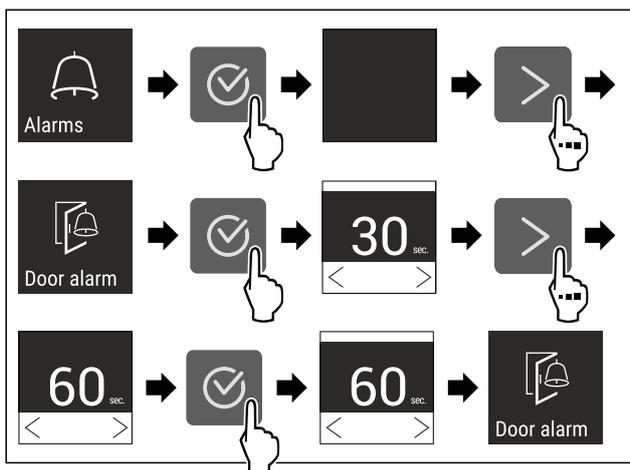
Fig. 172 Representación a modo de ejemplo: Cambiar alarma de puerta de 30 segundos a 60 segundos.
