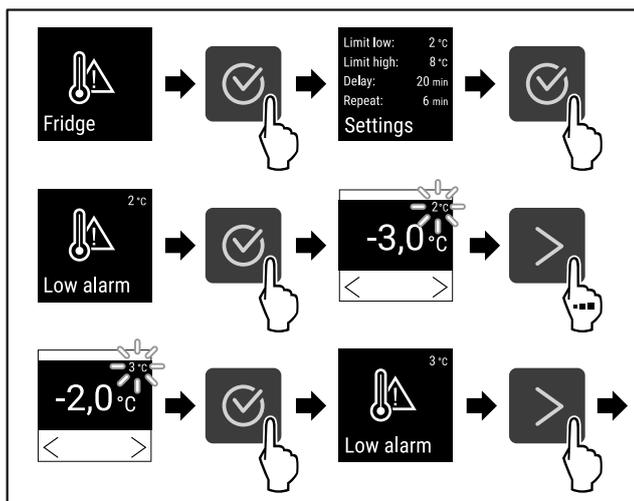
Fig. 162 Ejemplo de ajuste del límite inferior de temperatura basado en una temperatura de electrodoméstico ajustada de 5 °C.
