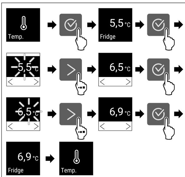
Fig. 91 Cambio de temperatura de 5,5 °C a 6,9 °C
