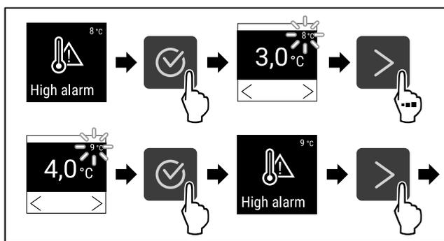
Fig. 163 Ejemplo de ajuste del límite superior de temperatura basado en una temperatura de electrodoméstico ajustada de 5 °C.
