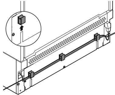
Montare i portacavi sul retro dell'apparecchio. Inserire il cavo di rete/tubo dell'acqua nei portacavi.
