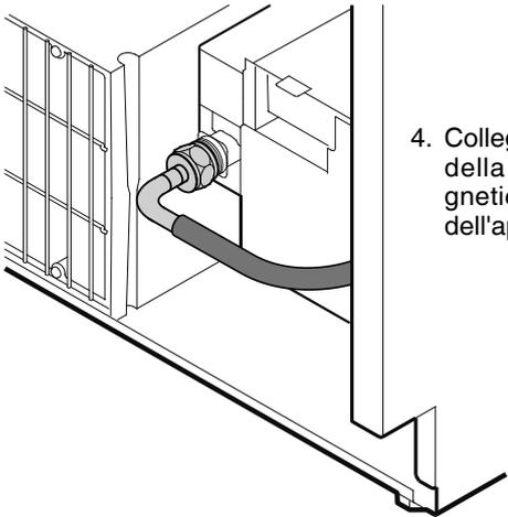
4. Collegare il tubo flessibile della valvola elettromagnetica al lato anteriore dell'apparecchio.
