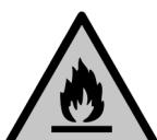
Το σύμβολο βρίσκεται στον συμπιεστή και επισημαίνει τον κίνδυνο από εύφλεκτα υλικά. Μην αφαιρείτε το αυτοκόλλητο.
